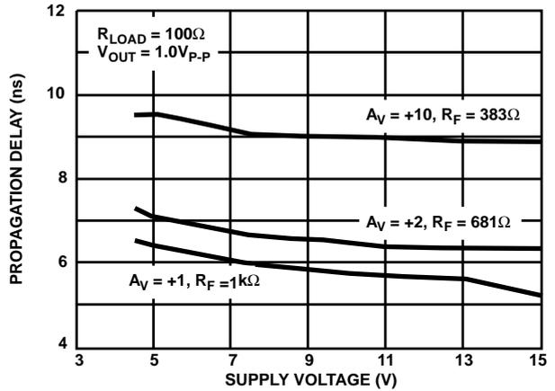
FIGURE 14. PROPAGATION DELAY vs SUPPLY VOLTAGE
