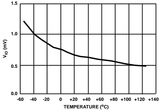
FIGURE 19. INPUT OFFSET VOLTAGE vs TEMPERATURE
