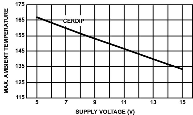
FIGURE 37. MAXIMUM OPERATING AMBIENT TEMPERATURE vs SUPPLY VOLTAGE
