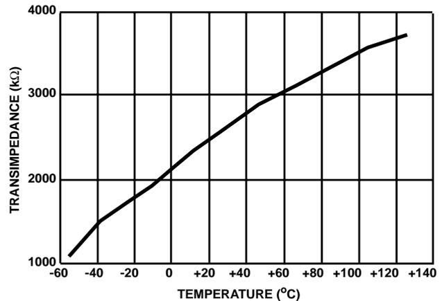
FIGURE 22. TRANSIMPEDANCE vs TEMPERATURE
